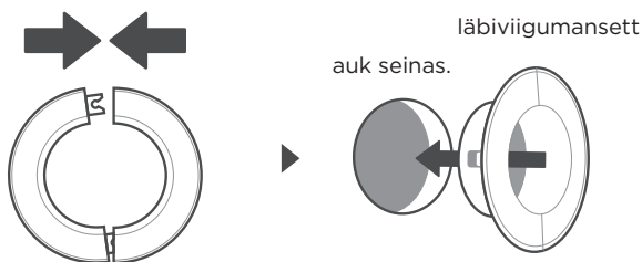
Paigaldage auku mansett.
